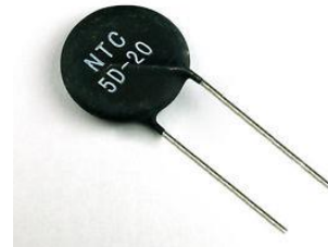
شكل رقم ١٤٦: رمز وشكل المقاومة الحرارية السالبة
