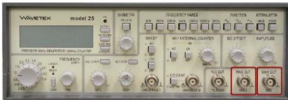
شكل رقم ٤٦: مفاتيح ضبط المخارج
