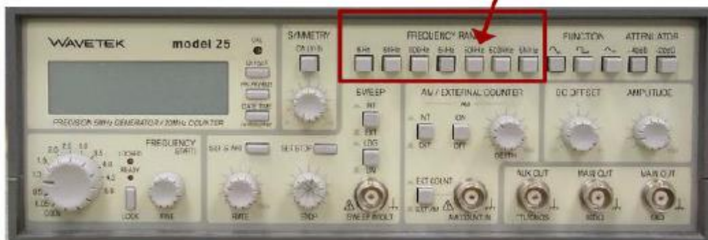
شكل رقم ٤٤: مفاتيح ضبط الترددات
