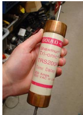
شكل رقم ١٢٥: الفيوز الضخم ذو قدرة التحمل الكبيرة (Huge Fuse)
