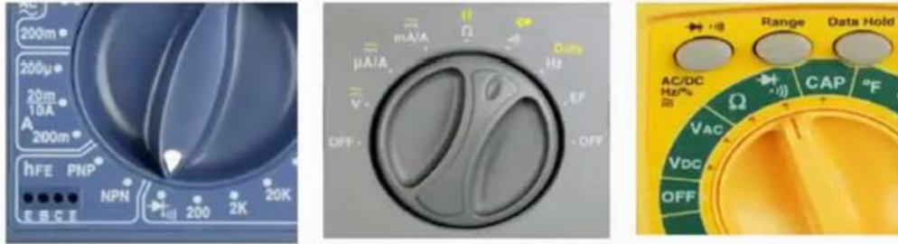
شكل رقم ٣٦: مفاتيح فحص التوصيلية
