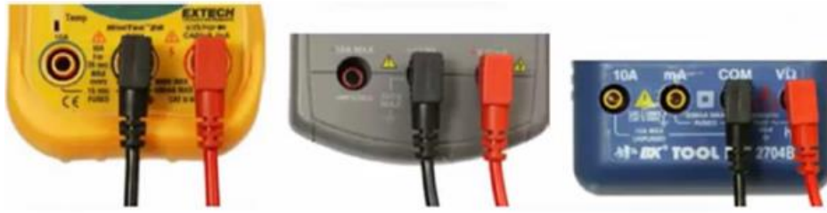
شكل رقم ٢٩: أطراف جهاز القياس متعدد الأغراض الرقمي
