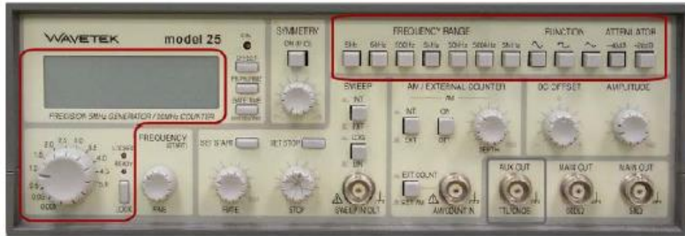
شكل رقم ٤٣: شاشة جهاز مولد الإشارات
