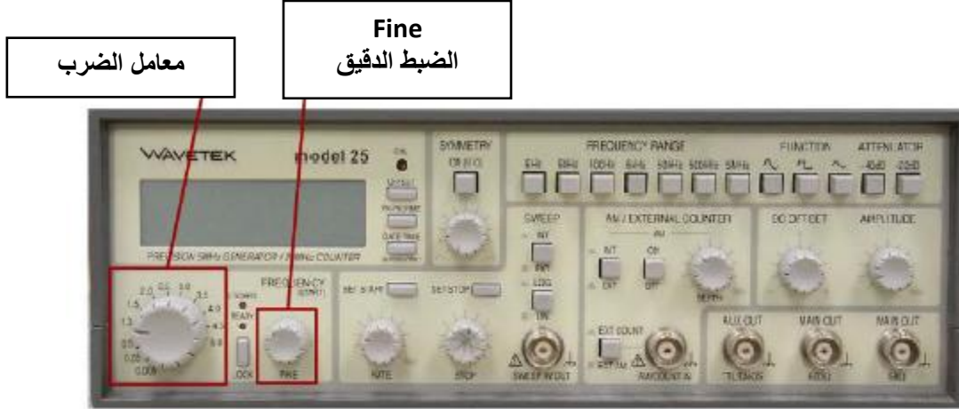
شكل رقم ٤٥: مفاتيح ضبط القيمة المطلوبة للتردد
