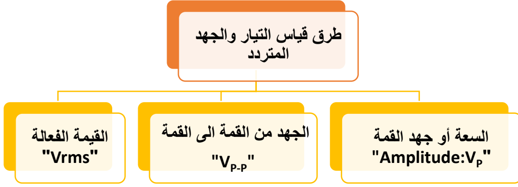
شكل رقم ١٥: طرق قياس جهد الموجات المترددة
