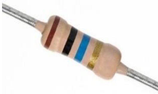
شكل رقم ٥٨: المقاومات الرباعية النطاقات اللونية
