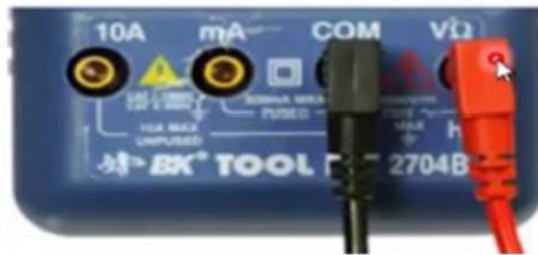
شكل رقم ٣٧: أطراف توصيل لفحص التوصيلية
