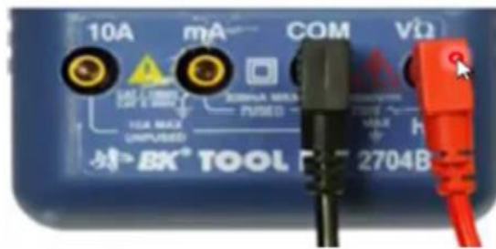
شكل رقم ٣٢: أطراف التوصيل لقياس الجهد
