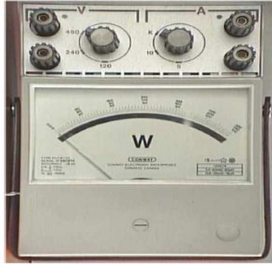
شكل رقم ٢٧: جهاز قياس القدرة الواط ميتر
