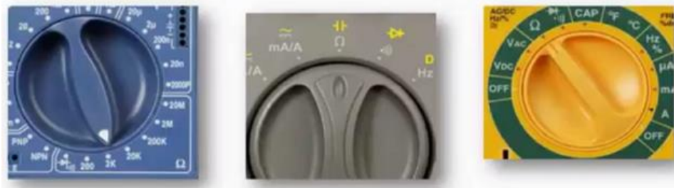
شكل رقم ٣٠: مفاتيح الاختيار بالجهاز الرقمي
